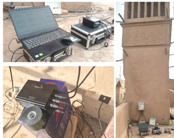
(پ) دستگاه آنالایز ارتعاشات DPS-DAQ
