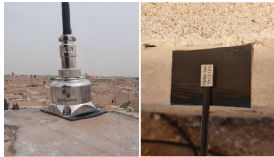
شتاب‌سنج سه‌جهته شبکه (VibNet 354) استفاده شده در خانه کرمانی
