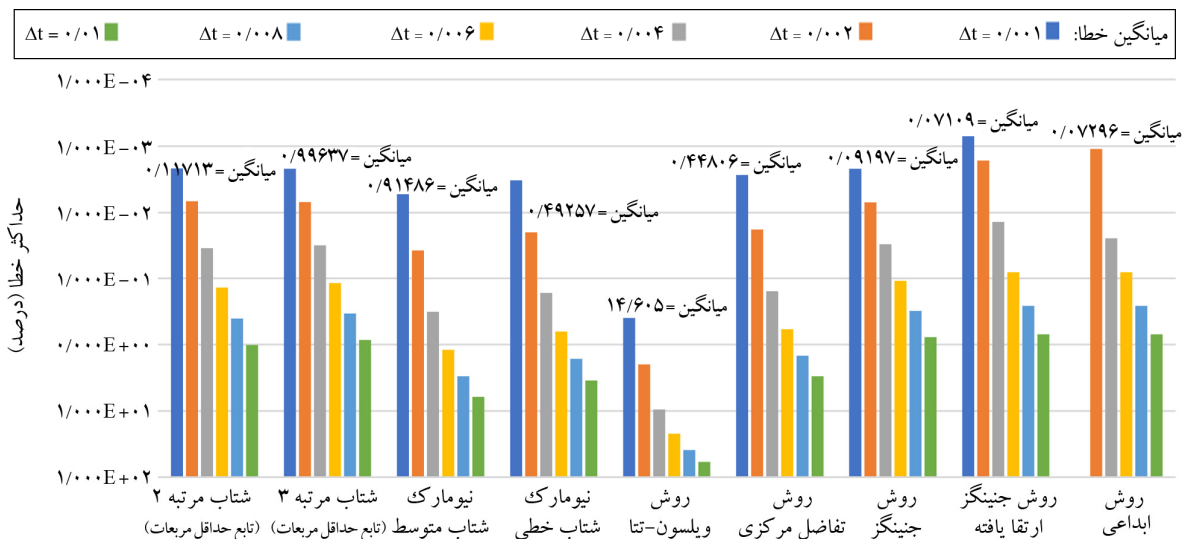
شکل (۶): میانگین خطای روش های مختلف عددی برای \Delta t از ۰/۰۰۱ تا ۰/۰۱ ثانیه ( \alpha = 2 ) و p_0 = 400 نیوتن.
