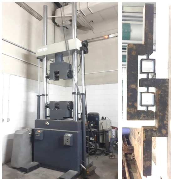
شکل (۴): دستگاه بارگذاری یونیورسال جهت اعمال بار به قطعه تحت آزمایش.
