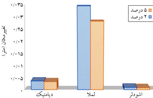
شکل (۹): جابه‌جایی در سه گنبد لملا، دیامتیک و اشودلر تحت میرایی های ۲ و ۵ درصد.
