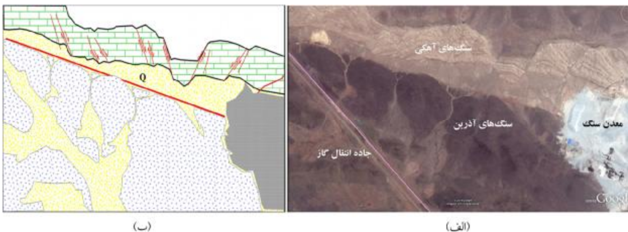
شکل (۱۳): (الف) تصویر ماهواره‌ای محدوده معدن سنگ در شمال ساوه. (ب) نقشه شماتیک از زمین‌شناسی محدوده معدن. واحدهای کواترنری با حرف Q مشخص شده است.
