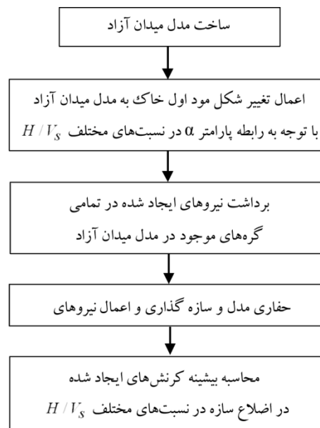
شکل (۴): مراحل ساخت و تحلیل و انجام پژوهش در طی بخش مدل‌سازی اجزای محدود.
