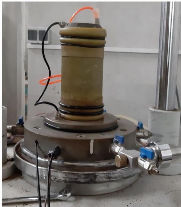
شکل (۲): نمونه‌ی رس نگه داشته شده تحت فشار مکشی ۳۰ کیلوپاسکال.
