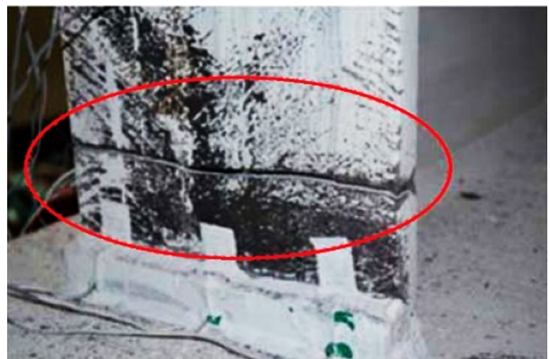
(الف) شکست بال پایینی تیر ریشه در شروع چرخه اول با زاویه دریافت ۵ درصد [۳]
