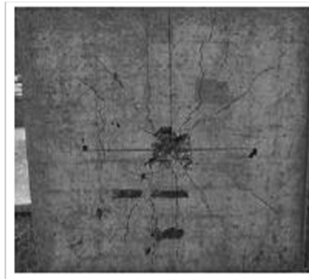
شکل (17): مقایسه نحوه گسترش ترکها در مدل های آزمایشگاهی و عددی در فاصله مقیاس شده 0/591
