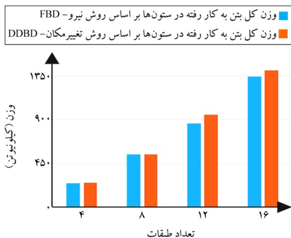
شکل (۱۵): مقایسه‌ی وزن کل بتن به کار رفته در قاب‌های هر دو روش.
