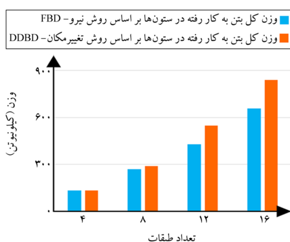
شکل (۱۸): مقایسه‌ی وزن کل بتن به کار رفته در ستون‌های هر دو روش نیرو و تغییر مکان.
