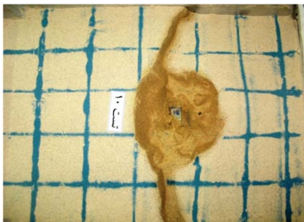
شکل (۱۵): سطح زمین مدل پس از آزمایش و فروچاله‌ی ایجاد شده
