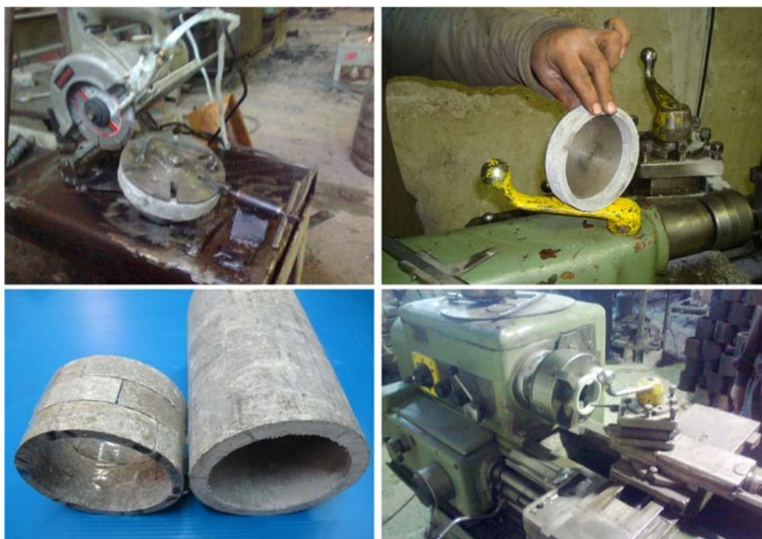
شکل (۱۱): تصاویری از ساخت تونل مدل قطعه‌ای از لوله آریست سیمانی
