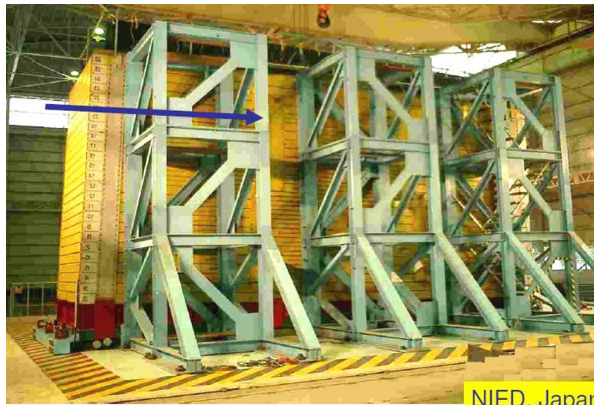
شکل (۱۰): میز لرزان و جعبه‌ی خاک مورد استفاده در آزمایش‌هی و همکاران [۴-۵].
