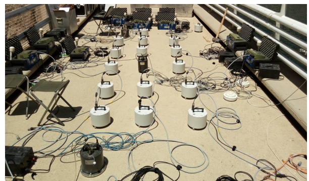
شکل (۴): چیدمان حس‌گرها در آزمایش کالیبراسیون دوم روی تاج سد.
