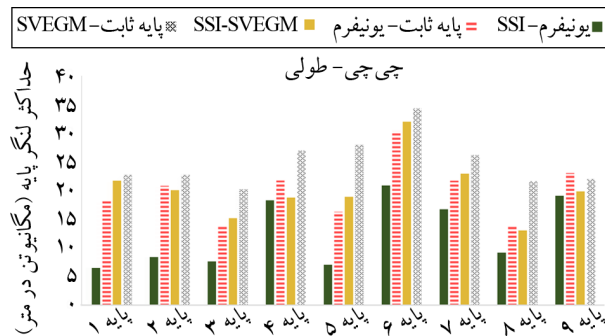
شکل (۱۸): حداکثر لنگر پایه برای زلزله چی‌چی (۱۹۹۹) در شرایط مختلف در نظرگیری یا عدم در نظرگیری اندرکنش و تحریک غیر یکنواخت.
