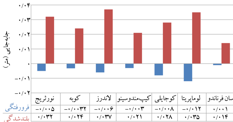
شکل (۲۹): نمودار بلند شدگی و فرورفتگی ستون دارای حرکت گهواره‌ای.
