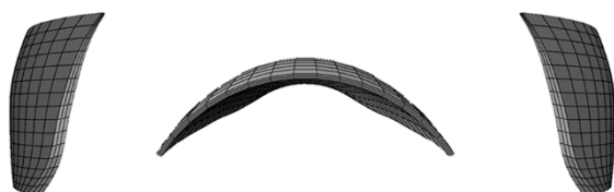
شکل (۲): مدل المان محدود سد بتنی قوسی ماروپوینت.
