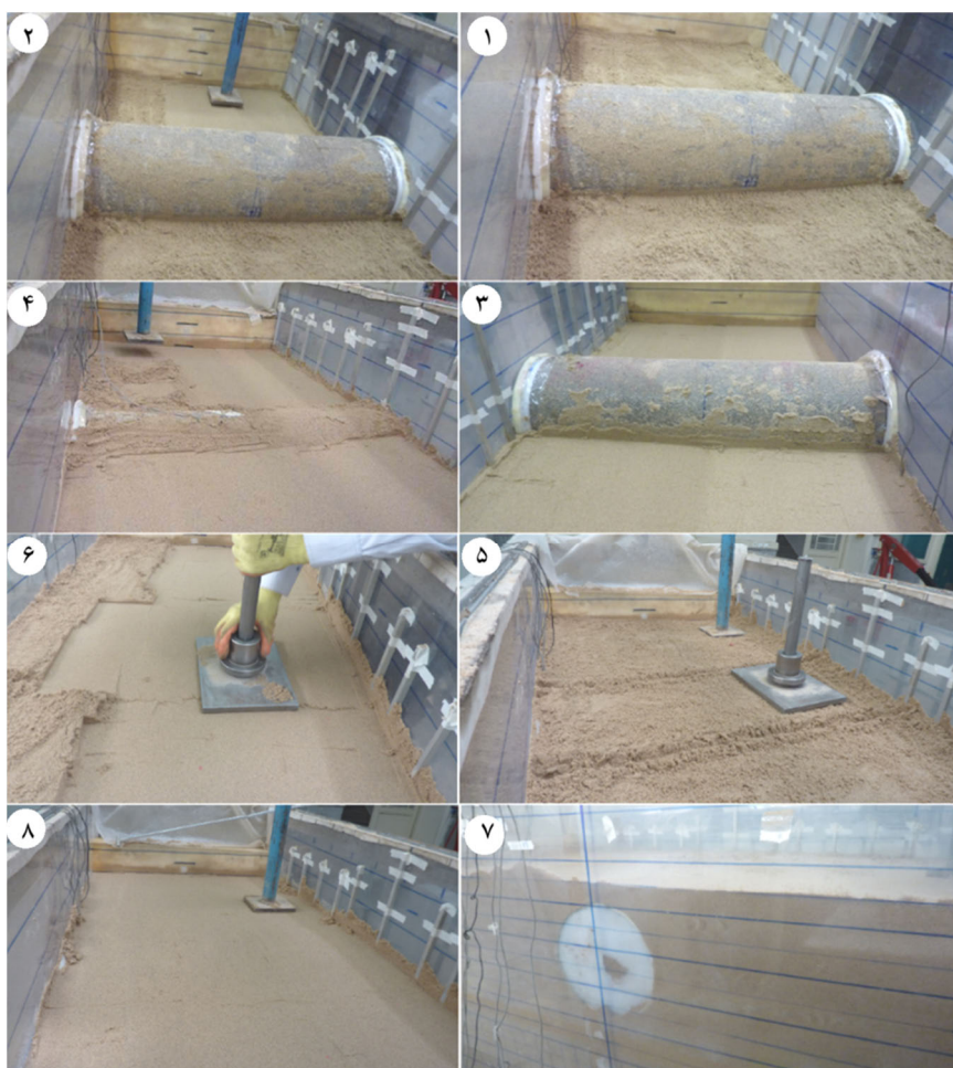
شکل (3): ترتیب اجرای روش ساخت لایه به لایه در مدل با تونل
