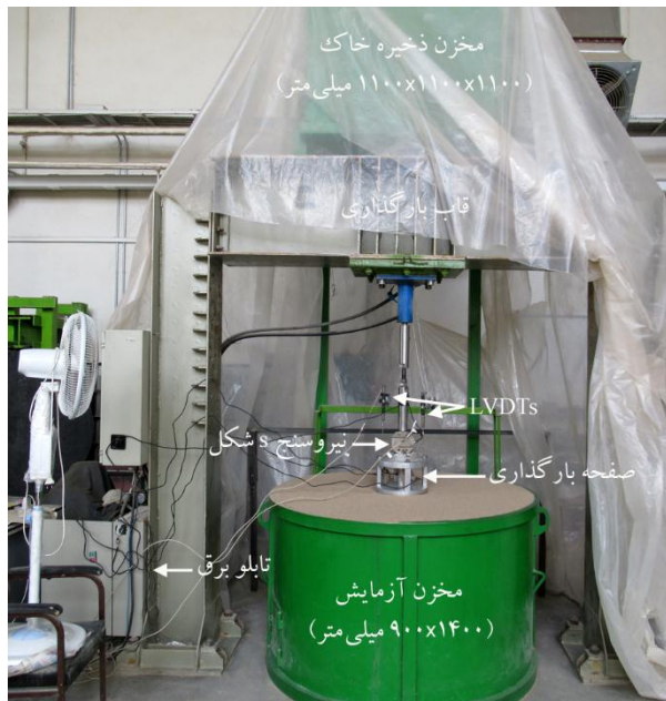
شکل (۲): نمای مقابل سیستم آزمایشگاهی طراحی و ساخته شده به همراه ضمايم و ملحقات آن.
