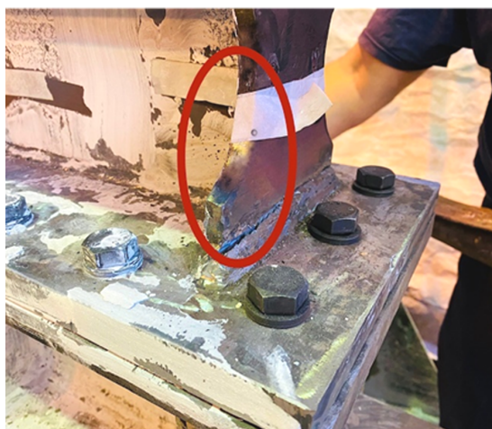
شکل (۱۲): تغییر شکل در وسط بال نمونه ۱ آزمایشگاهی تحت بارگذاری چرخه ای.
