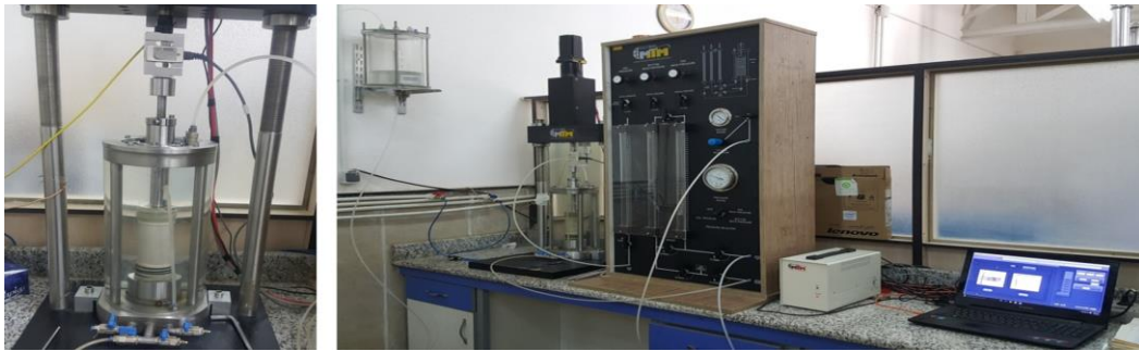
شکل (۲): شمای کلی دستگاه آزمایش سه‌محوری تناوبی و نمونه آزمایش.
