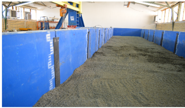
(ج) خاک ریزی لایه روی لوله
