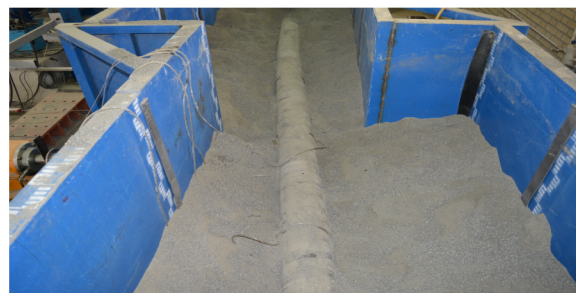
(ج) تغییر شکل ماندگار در لوله پس از برداشت خاک
