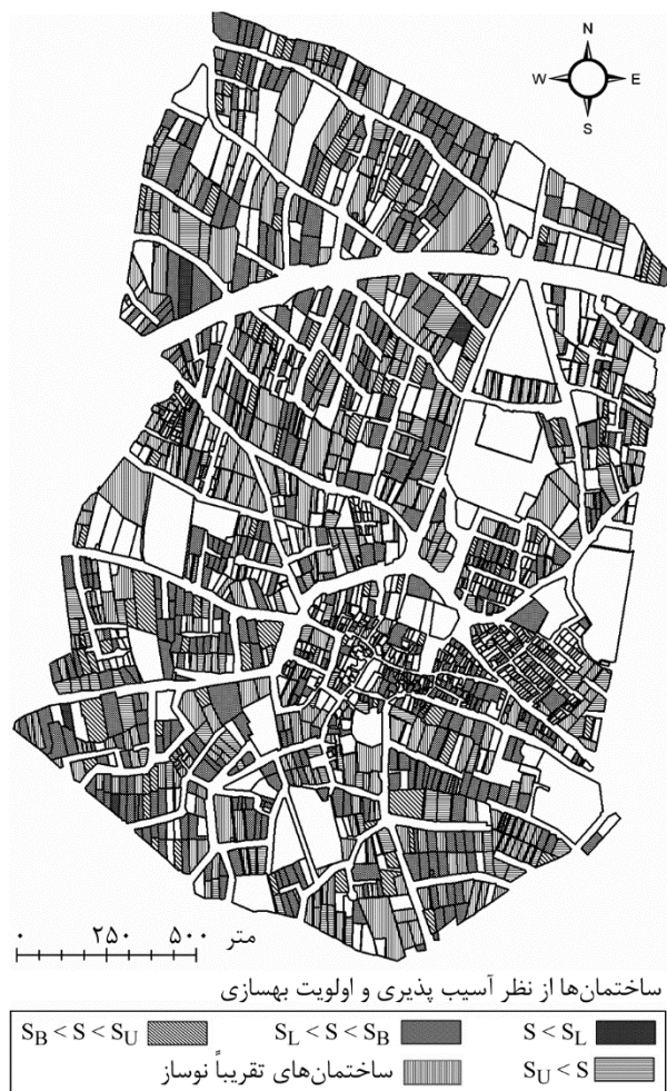
شکل (۲): وضعیت آسیب پذیری لرزه‌ای ساختمان‌های موجود از نظر اولویت بهسازی.
