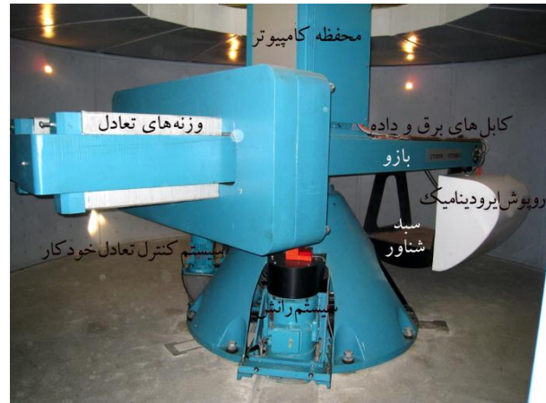
شکل (۱): نمایی از دستگاه سانتریفیوژ ژئوتکنیکی مورد استفاده در این تحقیق در دانشگاه تهران مدل C67-2.
