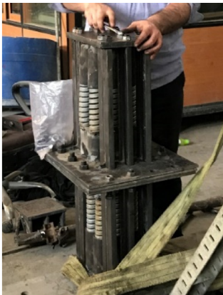
(الف) المان‌های تشکیل دهنده (ب) اتصال میراگر به صفحه میانی (پ) اتصال صفحه انتهایی به المان‌های محصور کننده
