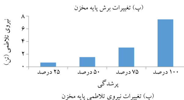
شکل (۱۴): رفتار لرزه ای مخزن آب هلال احمر در حالات مختلف پرشدگی و با در نظر گرفتن تکیه گاه گیردار.
