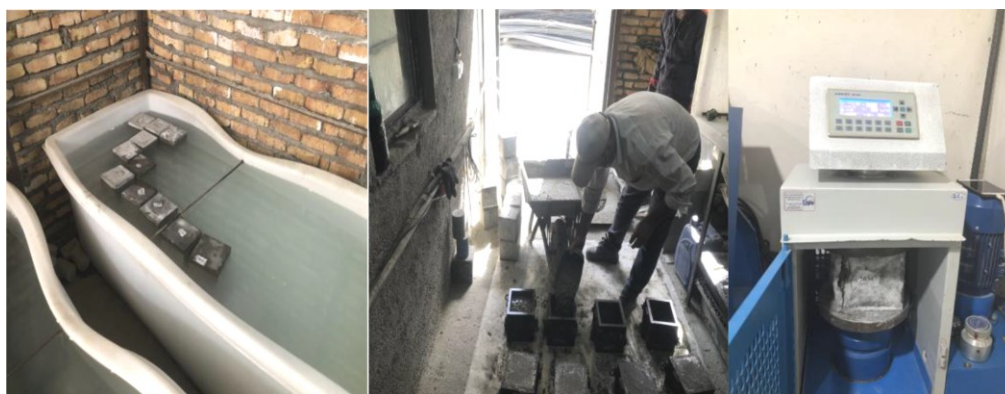
شکل (۶): آماده‌سازی نمونه‌های بتنی و آزمایش فشاری و کششی.
